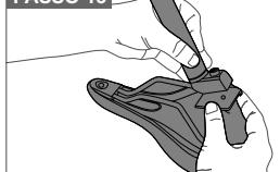
Para montar o selim da bicicleta, encaixe ele no canote e me seguida insira os parafusos. Após inserir os parafusos, aperte com uma chave allen 6mm.
