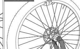
Em seguida encaixe a roda dianteira no garfo da bicicleta alinhando o disco entre as pastilhas de freio.
